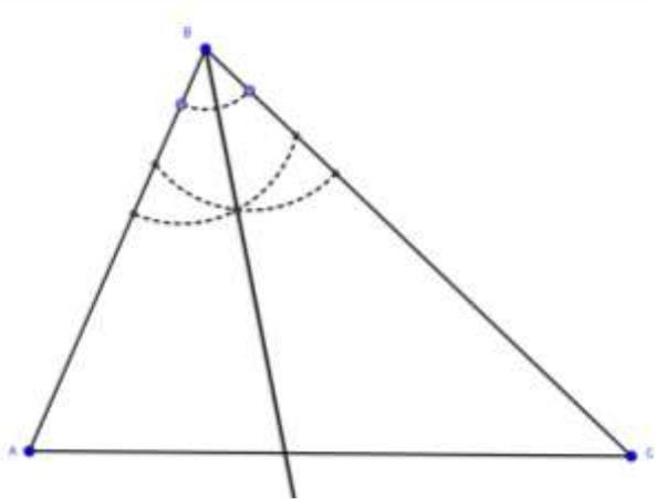
Para construir la bisectriz del ángulo C, colocas la punta del compás en C y trazas un arco de circunferencia que corte a los lados  $\overline{CA}$  y  $\overline{CB}$ , posteriormente, colocas la punta del compás en cada una de las intersecciones anteriores y trazas arcos de circunferencia con la misma abertura del compás. La bisectriz se construye desde C hasta la intersección obtenida.
