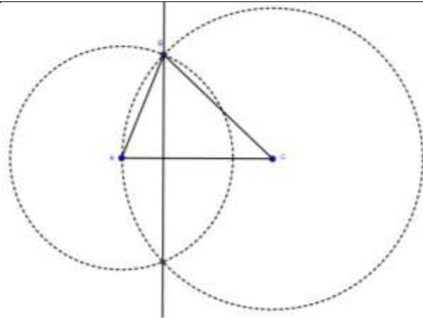
Para construir la altura del vértice A, colocas la punta del compás en B y abres hacia A y trazas una circunferencia o arco, posteriormente, colocas la punta del compás en C y abres hacia A y trazas una circunferencia o arco que intersecte a la circunferencia o arco anterior. La altura se traza desde A hacia la intersección de las circunferencias.
